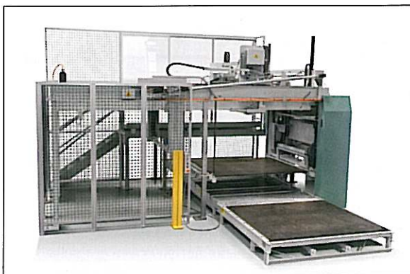
Автоматическая смена поддонов происходит на скорости до 300 м/мин при полном отсутствии отходов.
